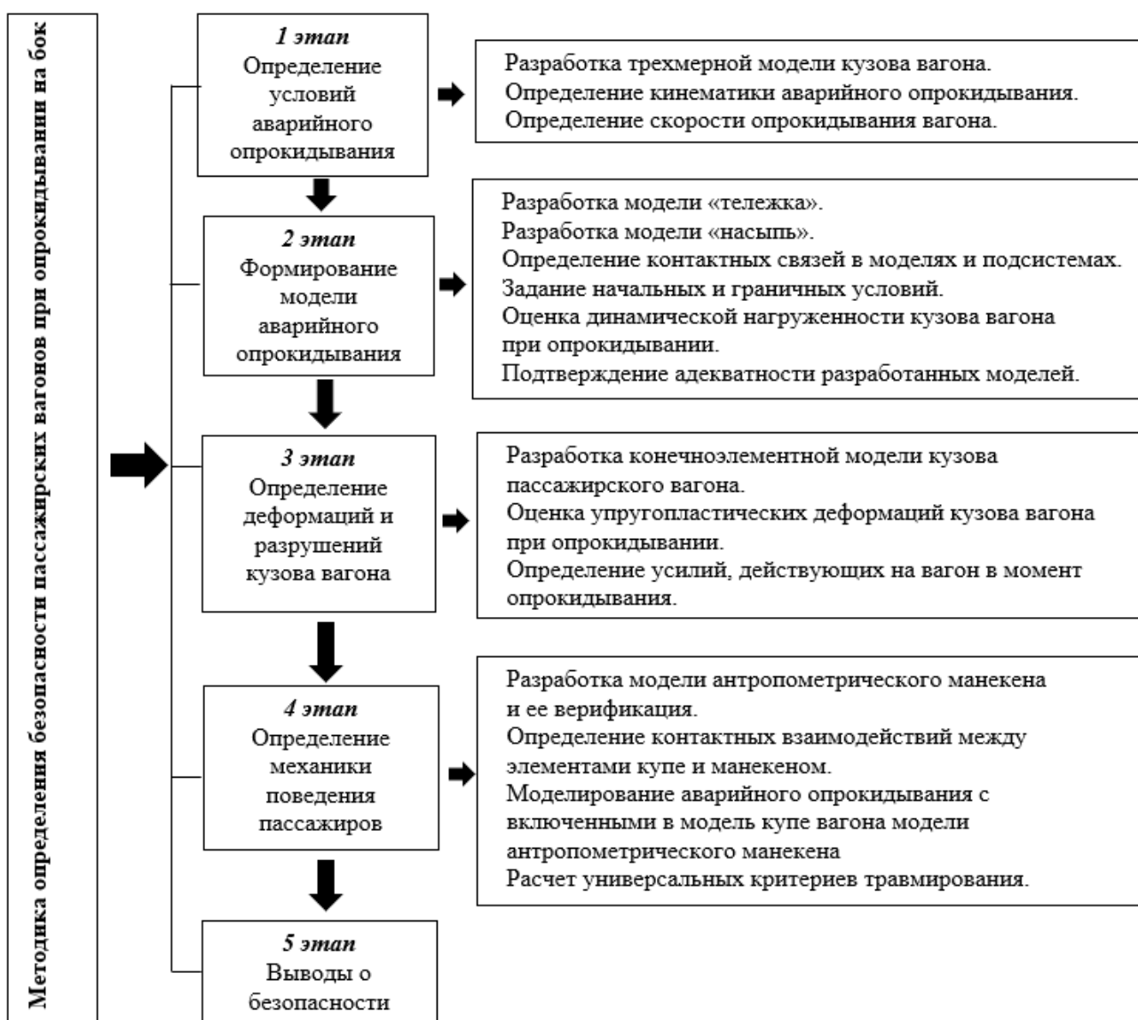
Рисунок 2.4 – Блок-схема методики определения безопасности пассажирских вагонов при опрокидывании
